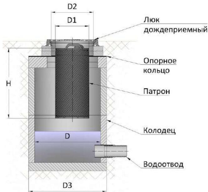
Рис. 4. Габариты ливневого колодца и фильтрующего патрона
