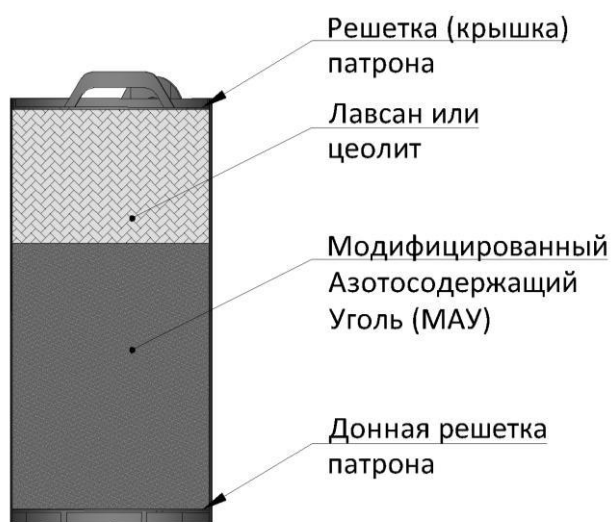
Рис. 3. Загрузка патрона фильтрующим элементом
