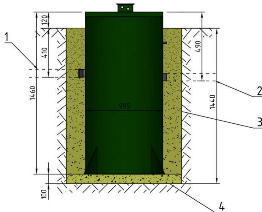
При монтаже оборудования в водонасыщенный грунт с риском обвала котлована следует применять деревянную опалубку. Для изготовления опалубки использовать обрезную доску 50мм.
