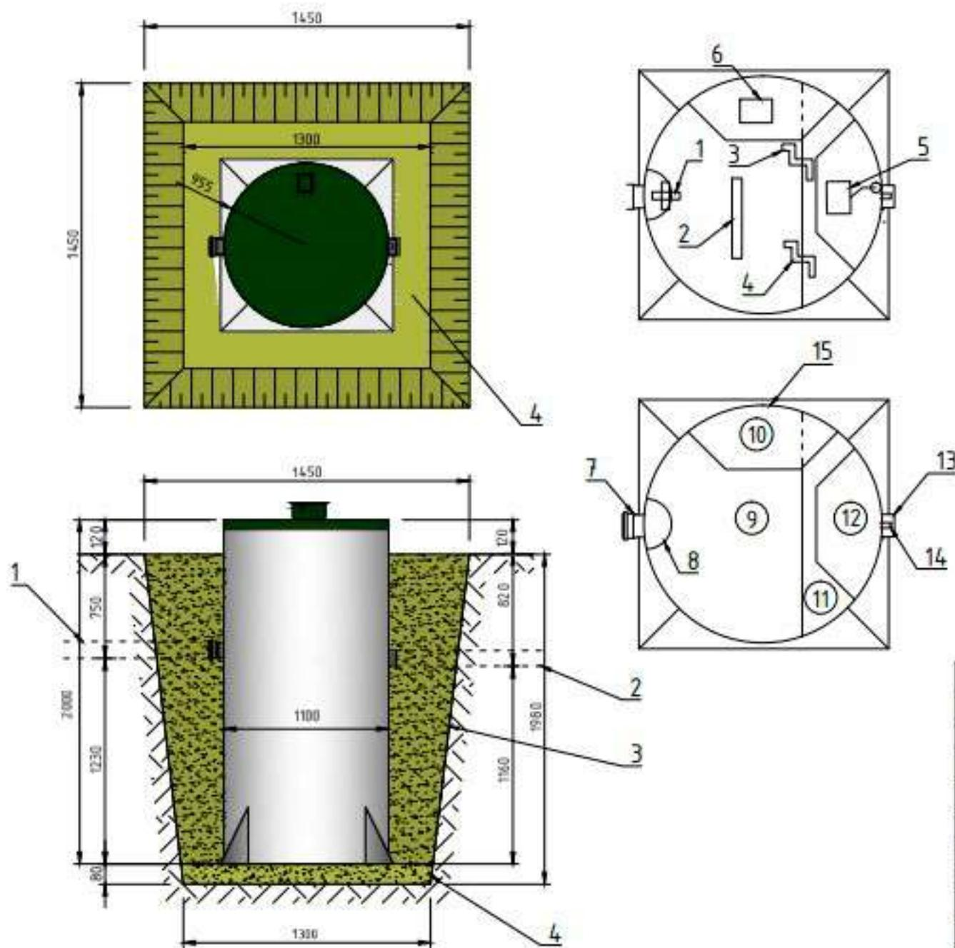
При монтаже оборудования в водонасыщенный грунт, с риском обвала котлована, следует применять деревянную опалубку 1600\*1600 Н=1500. Для изготовления опалубки использовать обрезную доску 50мм.
